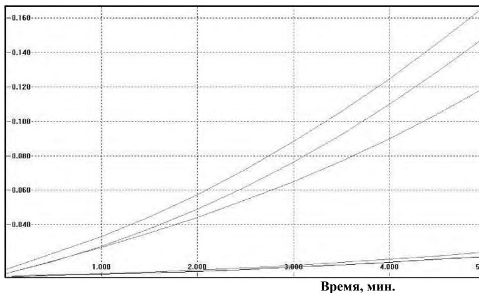
Рисунок 1. Зависимость оптической плотности ( $\lambda=347$  нм) от времени. Бутилированные воды в порядке увеличения D: Шишкин лес, Святой источник, Архыз, БиоВита, Evian, БонАква
