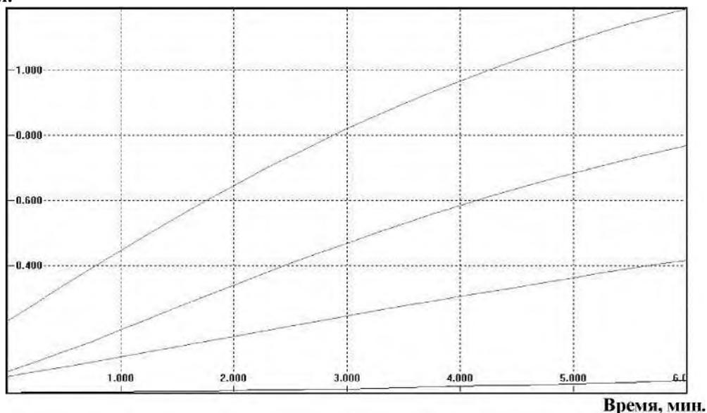
Рисунок 2. Зависимость оптической плотности ( $\lambda=347$  нм) от времени в порядке увеличения оптической плотности: дистиллированная вода, анолит водопроводной воды, католит водопроводной воды, водопроводная вода.
