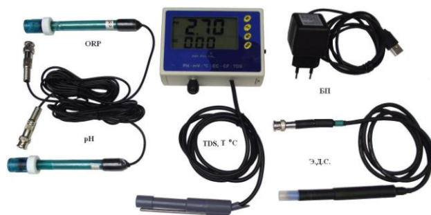
Рис.1. Состав комплекса "ДСИ-1" – 5 датчиков pH, ОВП, T, TDS, ЭДС (датчики TDS и T – два в одном), блок питания и измеритель РНТ-028.
