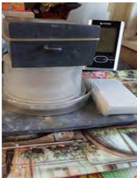
Рис. 2. Лабораторное устройство для изучения гамма-излучения при брожении дрожжей
