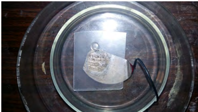
Рис. 2. Катод из никеля под диэлектрической пластинкой
