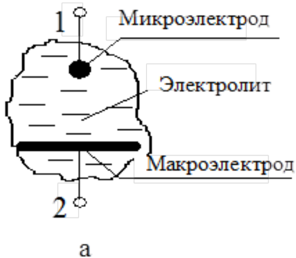
Рис. 1.1 Электрохимическая ячейка (а) и ее вольт-амперная характеристика (б).
